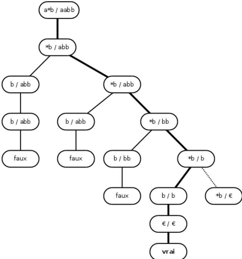
On a là un exemple typique de procédure d'exploration d'un espace de possibilités par *backtracking* : on explore une alternative en conservant la possibilité de revenir en arrière.
