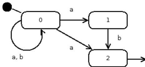
**Un mot  $w$  est reconnu** par un automate non-déterministe si et seulement il existe un chemin dans l'automate
