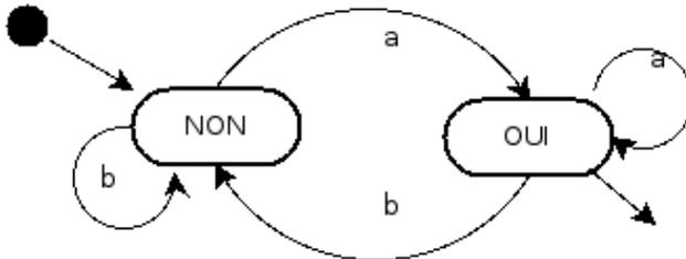
On part de l'état de gauche, on suit les flèches au fur et à mesure de la lecture des lettres du mot à reconnaître, et à la fin on sait que le mot est reconnu si on est arrivé dans l'état OUI. C'est la notion d'automate
