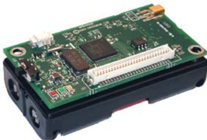
FIG. 5.2 – Un capteur Crossbow Mica2
