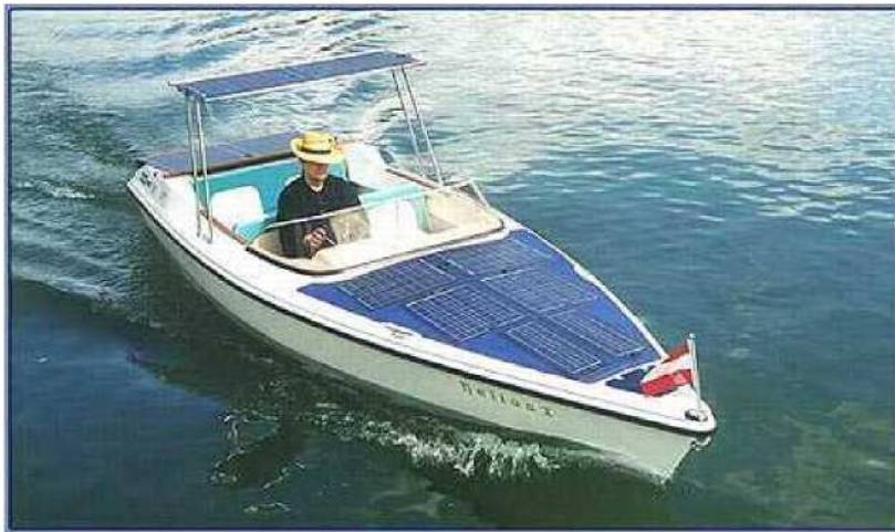
Figure 17 : Bateau avec un système de recharge PV embarqué.
