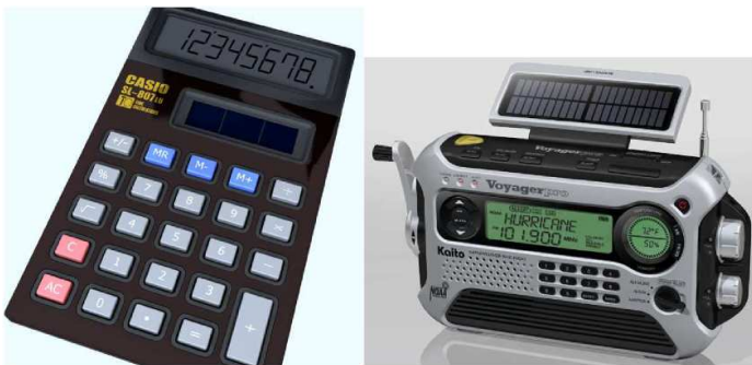
Figure 20 : calculatrice et radio alimentés par panneaux solaires.
