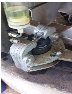
Figure 2 - Piston de frein hydraulique défectueux
