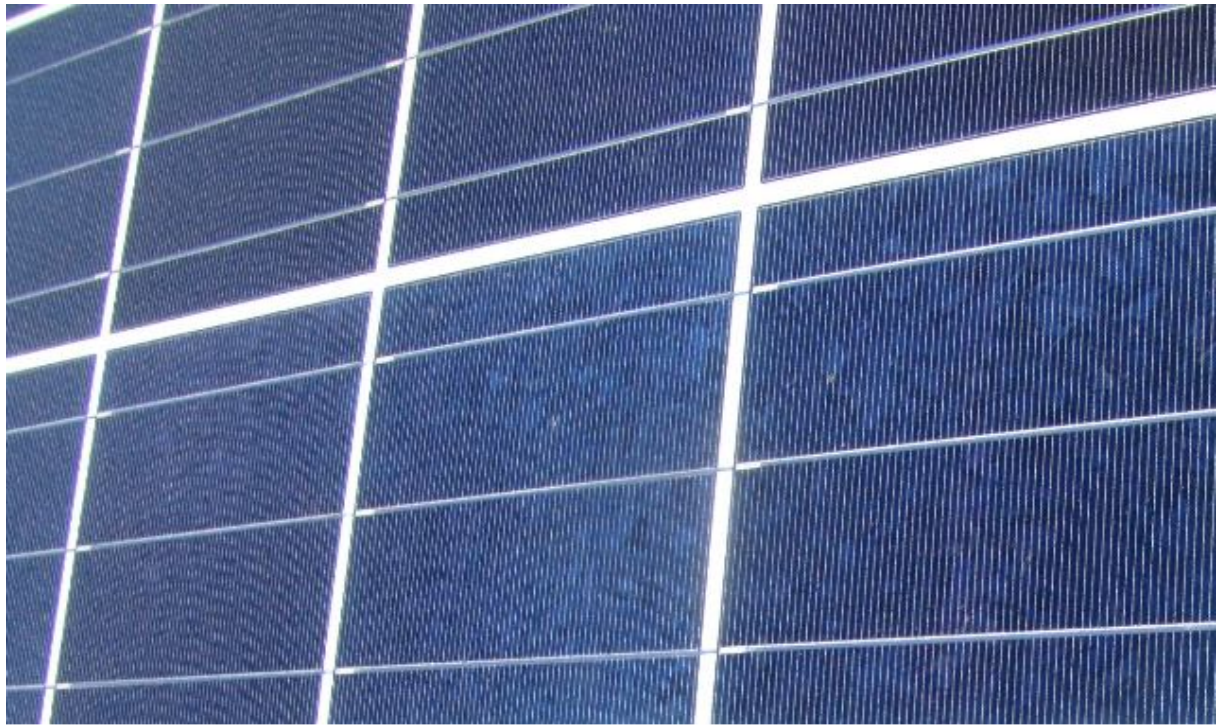
Fig 3: Στοιχεία πολυκρυσταλλικού πυριτίου
