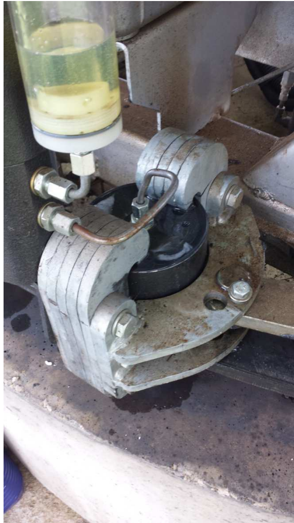
Εικόνα: Έμβολο πέδησης με διαρροή
