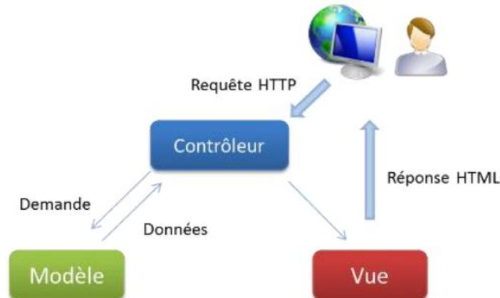
Dans le cas du framework Django, l'architecture est légèrement différente : Django gère lui-même la partie contrôleur. On parle alors d'architecture Modèle-Vue-Template (MVT). Le Template est un ensemble de fichiers HTML, appelé « gabarits », qui servent à la Vue pour afficher ce que le *client* voit sur son navigateur. Django permet d'utiliser des structures conditionnelles afin de rendre l'affichage dynamique en fonction des actions de l'utilisateur et de l'état courant du site.
