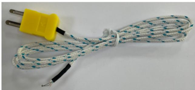
Sonde thermocouple de type K
