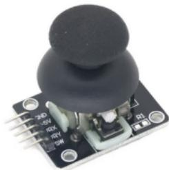
Le module joystick du kit arduino contient 2 potentiomètres de 10k et 1 bouton.
