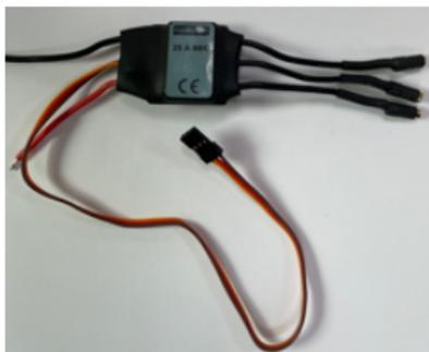
Les ESC des images à gauche sont utilisés pour les drones et avions réduits. Il n'ont pas de radiateur car le flux de l'air les refroidit. De plus, ils font tourner les moteurs dans un seul sens. Si vous les utilisez pensez à refroidir à la fois l'ESC et le moteur.
