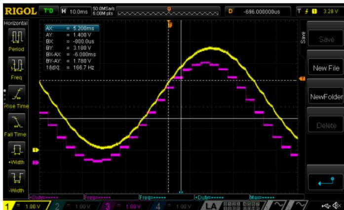
La résistance R105 et le condensateur C16 doivent être choisis en fonction du signal à restituer, de la période d'échantillonnage choisi et de la distorsion que l'on souhaite obtenir vis à vis de la forme du signal choisi.
