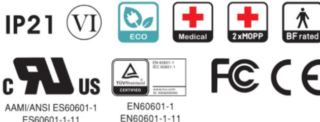
Le niveau 2xMOPP, resp. 2xMOOP, indique une double protection pour le patient, resp. l'opérateur. L'un ou bien l'autre est nécessaire à la qualification SELV.
