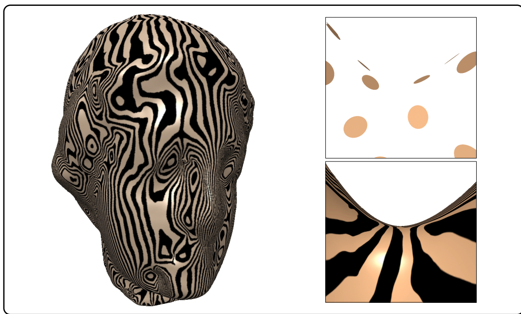
FIG. 5.25 – Mise en évidence des variations de normales et de courbures par des lignes de réflexions. À droite zoom sur le raffinement d’une configuration en “selle”.
