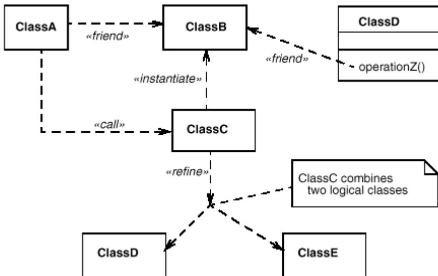
Un **diagramme de classes** (class diagram) montre la structure statique (et aucune information temporelle) d'un système. Un diagramme de classes est représenté par un graphe d'éléments (classes, types, interfaces, paquetages, ... et même instances) connectés par des relations. Le diagramme de classes de l'exemple « jouet » (ci-après).
