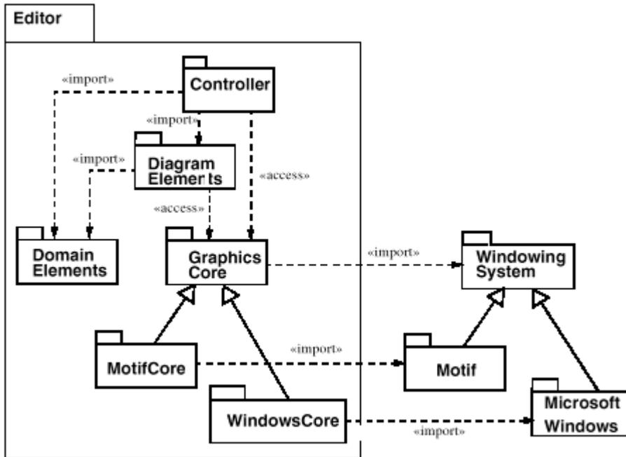
2<sup>nd</sup> exemple de paquetage : le paquetage Editor est présenté sous la forme d'un arbre (composé de trois autres paquetages).
