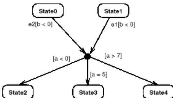
L'algorithme équivalent à la transition combinée allant de l'état State0 vers l'état State2 :
