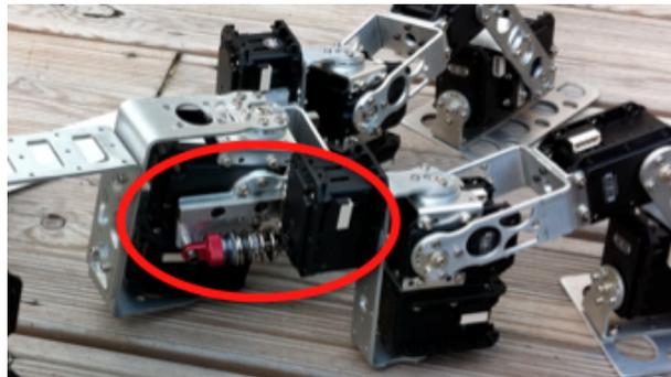
FIGURE 3.3 – liaison amortie dans la hanche
