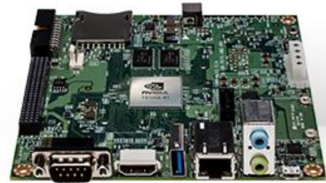
embarqué (ex. Jetson) (4 cœurs CPU + 200-300 cœurs GPU) [↔ supercalculateur en 2000]
