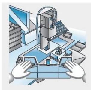
(a) Une machine à commande "bi-manuelle"
